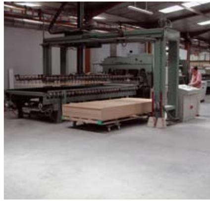
Notre ligne d'encollage automatisée nous permet de réaliser le placage de panneaux de toutes dimensions dans une longueur maximum de 4150 mm et une largeur maximum de 1660 mm.
