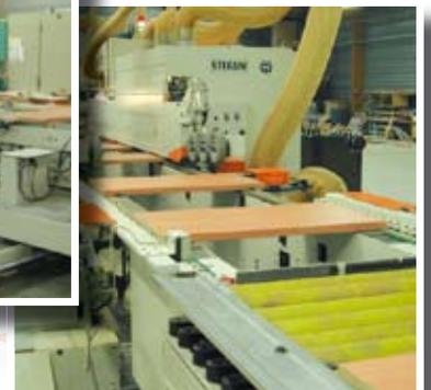
*Façonneuse / Plaqueuse double*
