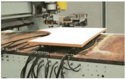
*Centre d'usinage et placage de chant pour pièces en forme*
